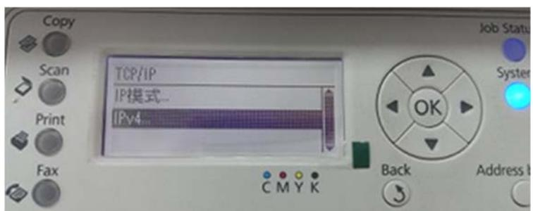
步驟 5、選擇「IP 位址的取得」，按「OK」鍵，按「▼」鍵，選擇「控制面板」，按「OK」鍵。**※當「IP 位址的取得」設定完成時，機器會要求重新開機，請按「返回」鍵，將下列步驟完成後，再重新啟動印表機電源。**
